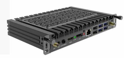
ZK-OPS (Open Pluggable Specification) es un accesorio de la pantalla inteligente, con un sistema Windows incorporado. El OPS puede instalarse directamente en la parte posterior de la pantalla digital interactiva, mejorando en gran medida la función y el rendimiento del dispositivo.
